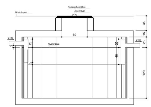
**05 CORTE - TANQUE SÉPTICO**
