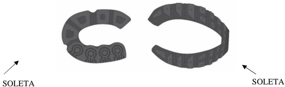
3 **REFORÇO DO ENFRANQUE** – Peça localizada na parte inferior do solado, na região lateral externa do enfranque de ambos os pés, conforme mostrado na figuras 2 e 3. É constituída de material polimérico na cor cinza.
