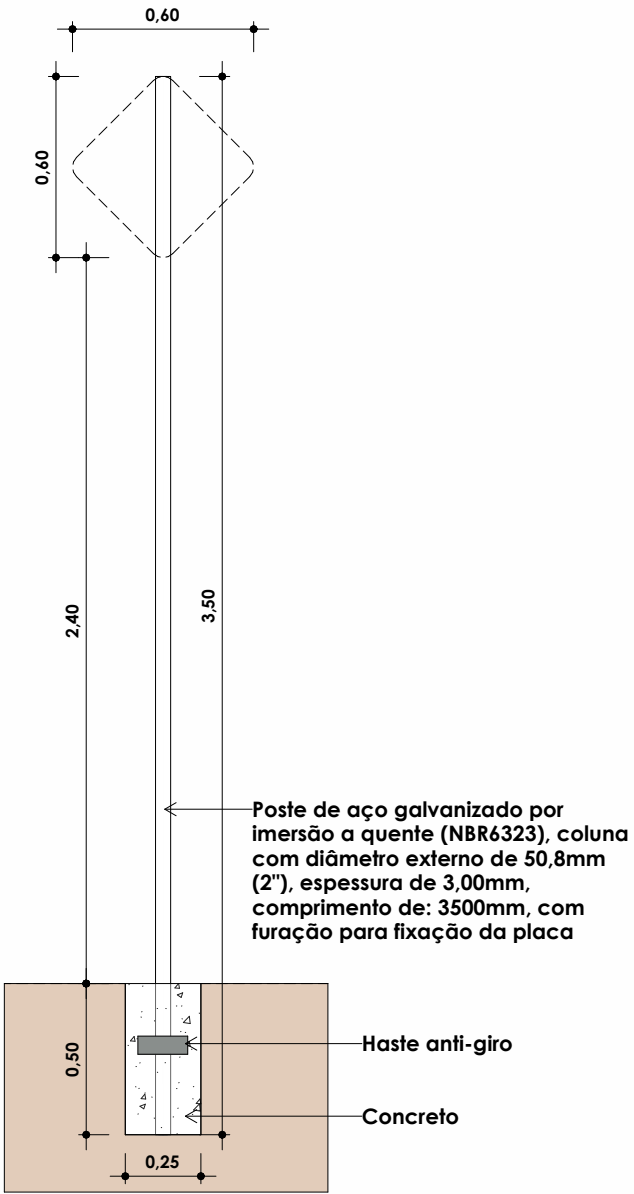
DETALHE - FIXAÇÃO DE POSTE ESC: 1 : 25
