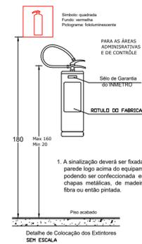
1. A sinalização deverá ser fixada na parede logo acima do equipamento podendo ser confeccionada em chapas metálicas, de madeira, fibra ou então pintada.
