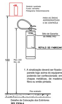
1. A sinalização deverá ser fixada na parede logo acima do equipamento podendo ser confeccionada em chapas metálicas, de madeira, fibra ou então pintada.
