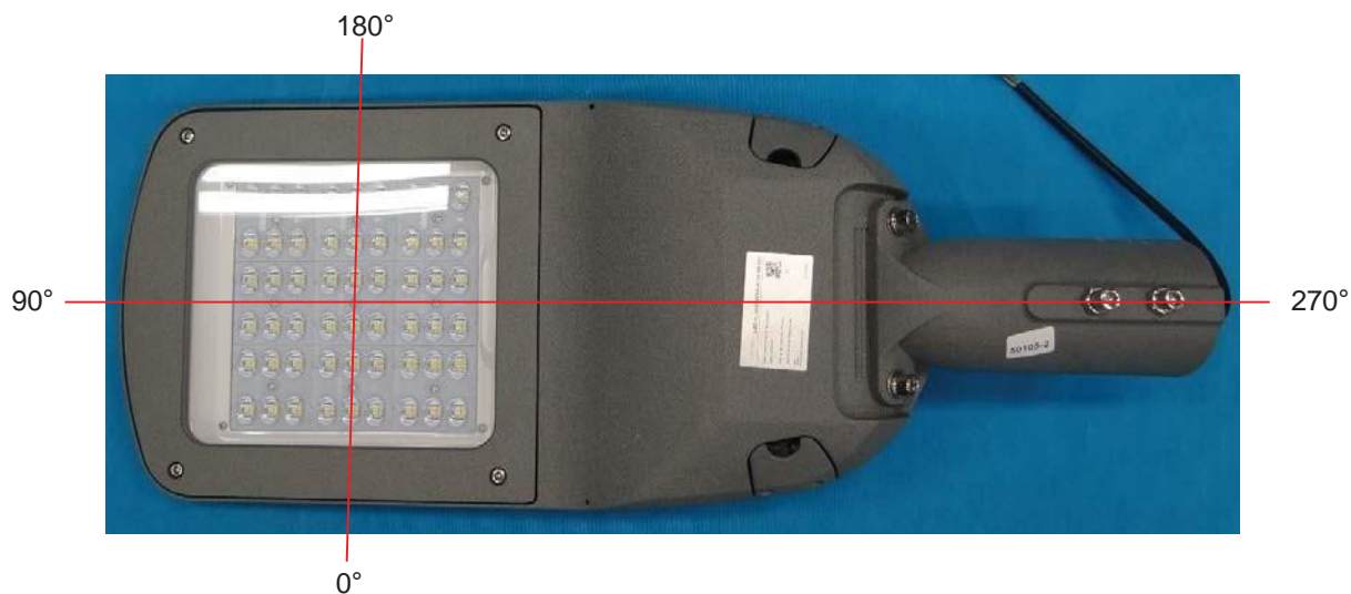
Foto 4 - Eixos fotométricos utilizados
