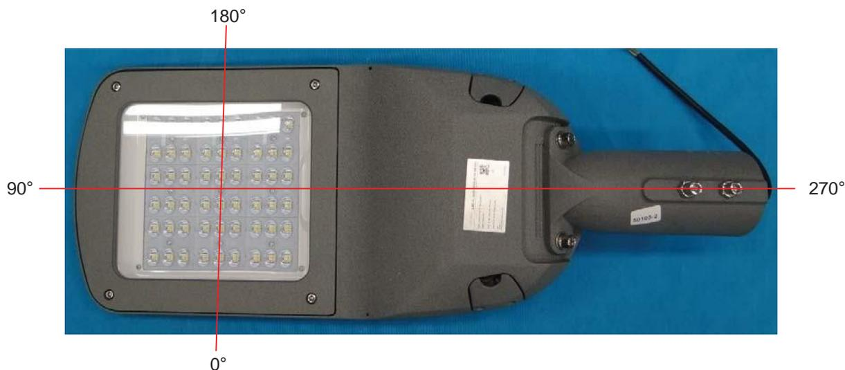
Foto 4 - Eixos fotométricos utilizados
