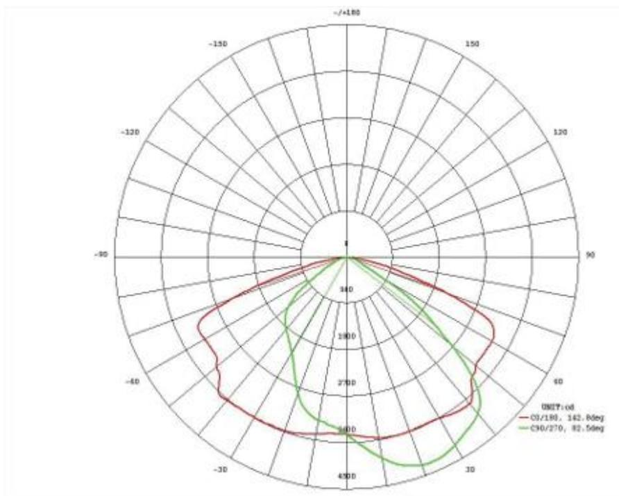
Figura 1 - Curva de distribuição de intensidade luminosa
